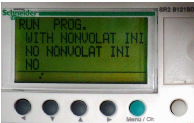
**16/** Recommencer l'étape n°3, sélectionner l'option «WITH NONVOLAT INI» et valider avec la touche E.
