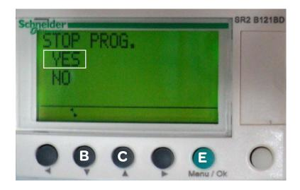
**4/** A l'aide des touches B et C sélectionner «YES» et valider avec E (arrêt du programme).
